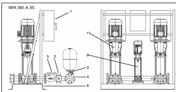
De acordo com o tipo de unidade, a electrobomba pode ser do tipo vertical ou horizontal. As conexões podem ser do tipo com rosca ou com flange conforme o modelo da unidade. Pode estar ou não estar presente a bomba jockey. O reservatório do combustível da motobomba diesel pode ser instalado por cima da unidade ou separado dependendo das dimensões. Os quadros eléctricos podem ser instalados na unidade ou separados no caso de armários de pavimento.
